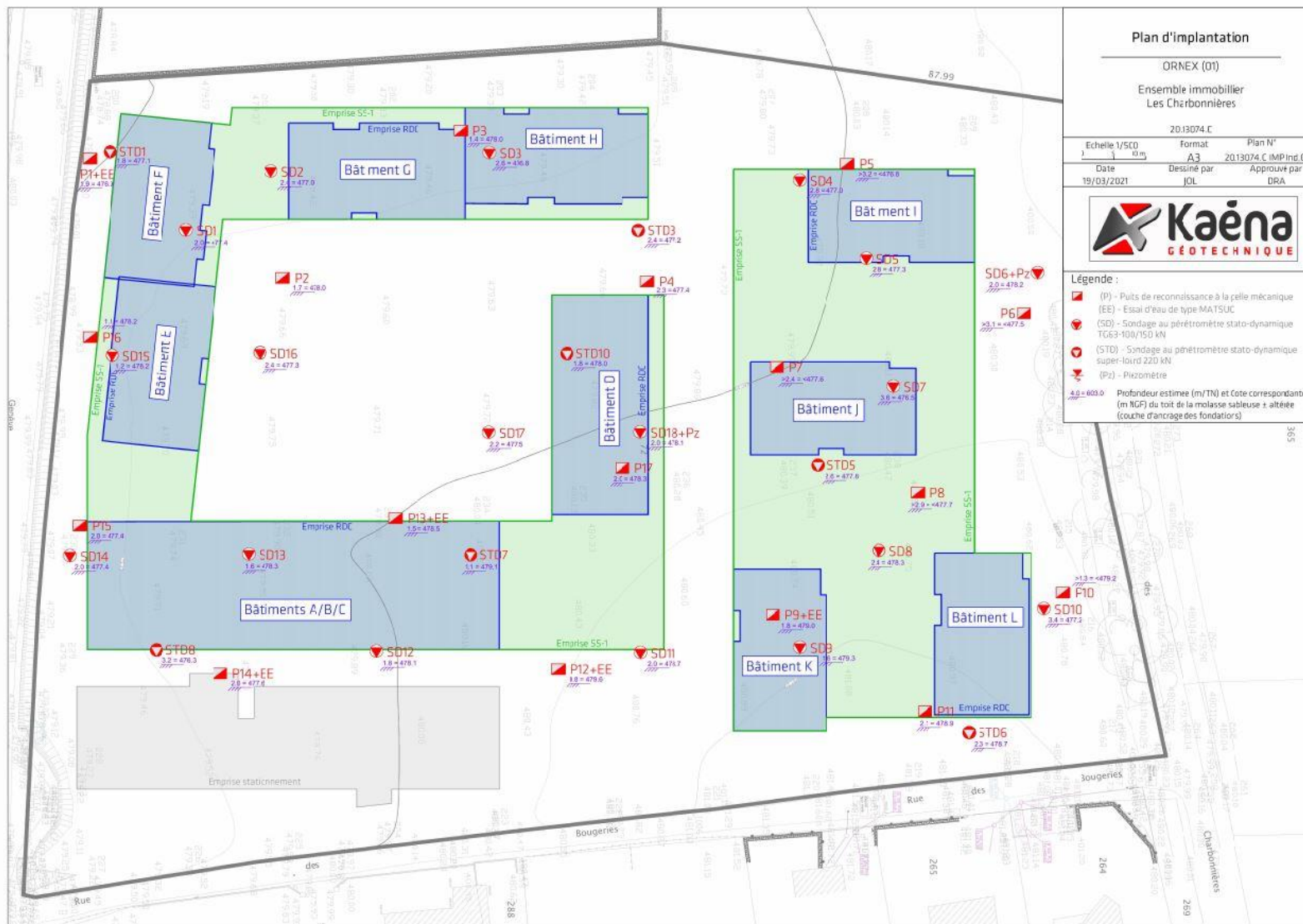
Figure 37 : Implantations des sondages réalisés dans le cadre de l'étude géotechnique G2AVP sur la parcelle du secteur d'étude. Source : KAENA, 2021
