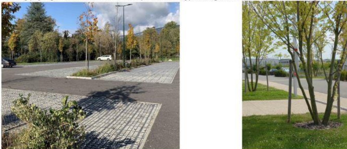
Figure 15 : Parkings perméables de type evergravier et accompagnement végétal des stationnements. Source : Atelier Fontaine, 2021
