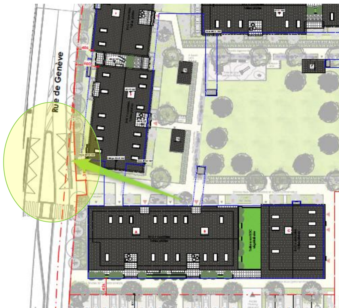
Figure 7 : Extrait du plan de masse du permis de construire localisant l'arrêt de bus du BHNS
