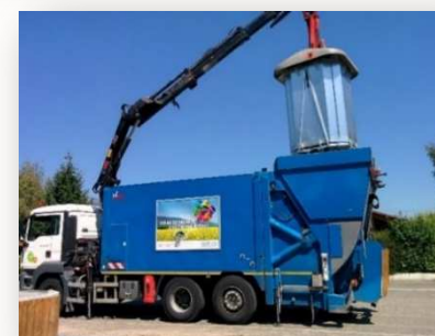
Collecte d'un conteneur semi-enterré avec un camion « Évolupac »
