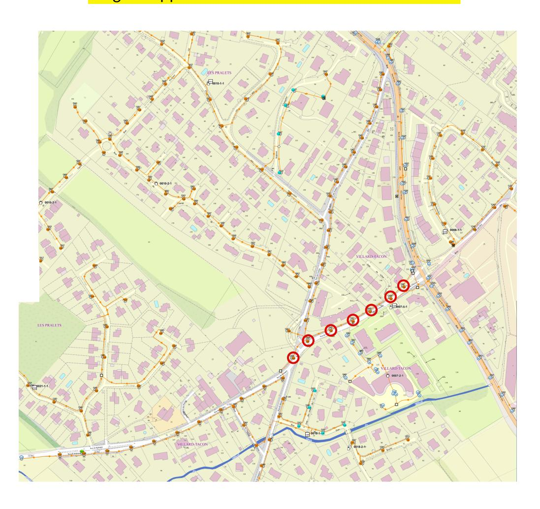
Ensemble EP à poser mât CC h:6m Luminaire INOA LED verre plat en top équipé 38W 1 coffret CL2 1 parafoudre
